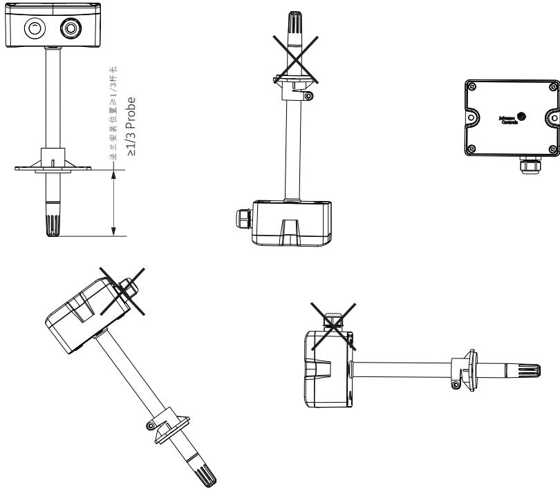
安装尺寸图 Installation Dimension(mm)
